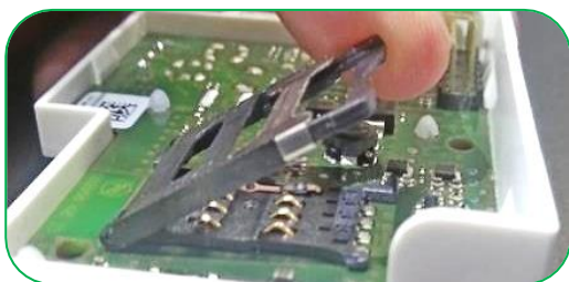
Rysunek 75: Podnoszenie metalowej osłony gniazda karty SIM
