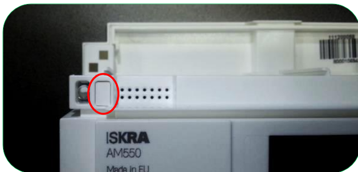
Rysunek 46: Czujnik otwarcia pokrywy modułu komunikacyjnego
