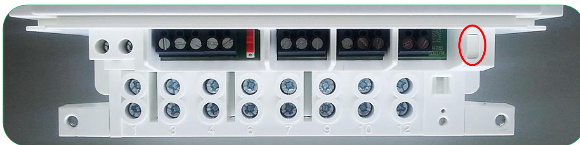
Rysunek 45: Położenie czujnika otwarcia pokrywy zacisków w liczniku trójfazowym
