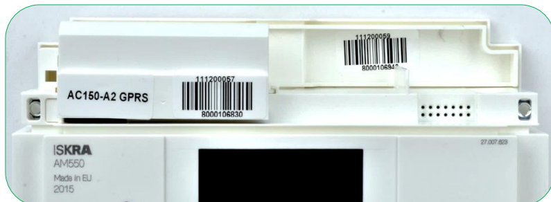
Rysunek 36: Umiejscowienie modułu komunikacyjnego w liczniku (na przykładzie modułu GPRS)
