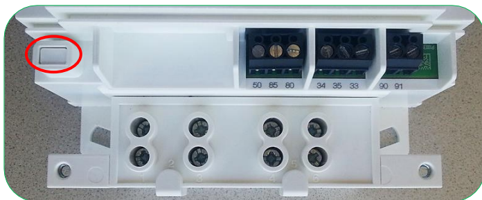
Rysunek 44: Położenie czujnika otwarcia pokrywy zacisków w liczniku jednofazowym
