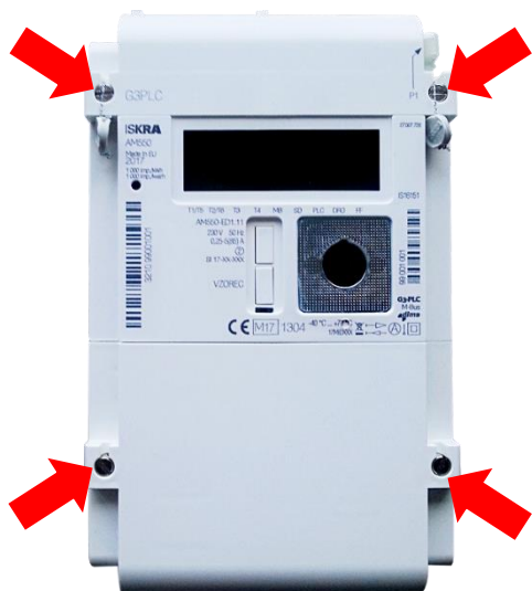
Rysunek 23: Rozmieszczenie punktów zabezpieczających jednofazowego licznika AM550
