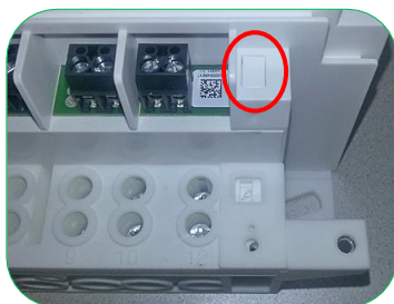
Rysunek 16: Położenie czujnika otwarcia pokrywy zacisków w liczniku trójfazowym
