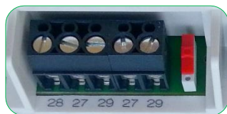
Rysunek 11: Zaciski RS-485 z opornikiem obciążeniowym
