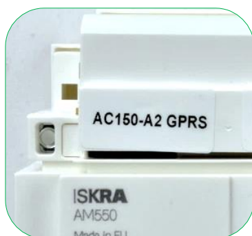
Rysunek 21: Umiejscowienie czujnika otwarcia pokrywy modułu komunikacyjnego
